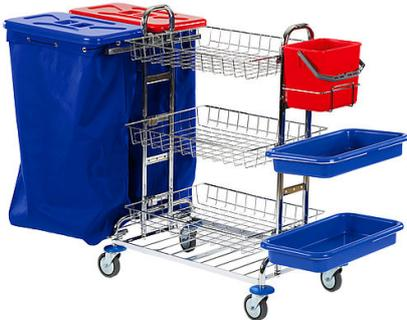
Verchromter Hotelwagen - made in EU - mit 3 großen Körben, 2 Utensilienwannen, 1 Putzeimer 6 l, eine Wäschesackeinheit 2x120 l. Der Bodenrost verhindert das Durchrutschen der Säcke, inklusive 4 Räder 100mm Durchmesser und Anfahrerschutz. Die Räder sind 360° drehbar. Die Verchromung ist stoßfest und resistent gegen Reinigungsmittel. *Deckel und Entsorgungssäcke sind nicht Bestandteil des Lieferumfangs, können aber optional bestellt werden.*
